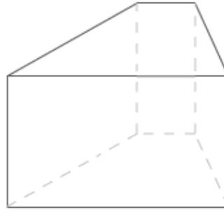
**Définition 14** La **hauteur** d'un prisme est la distance entre les deux plans de base, c'est à dire la distance entre un point d'une base et l'autre base. La hauteur d'un prisme droit est donc la longueur du côté de l'un des rectangles de la surface latérale, non situé dans une base.
